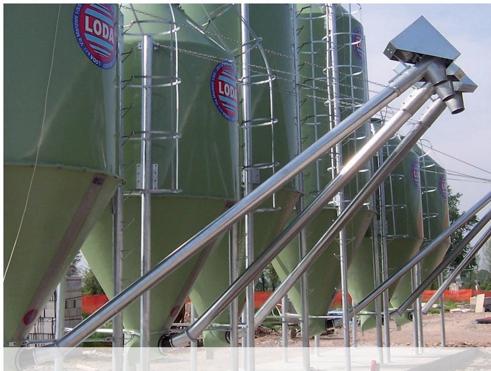
Die Silos werden aus Glasfaserkunststoff mit Teilen aus feuerverzinktem Eisen, zur Einlagerung von Futterstoffen, industriellen Erzeugnissen, Granulat sowie Pulver und Flüssigkeit im Allgemeinen hergestellt. Sie zeichnen sich aus durch perfekte Wärmedämmung, einfachen Transport, problemlose Montage, sowie die mühelose Kontrolle und Entleerung des eingelagerten Siloguts.
